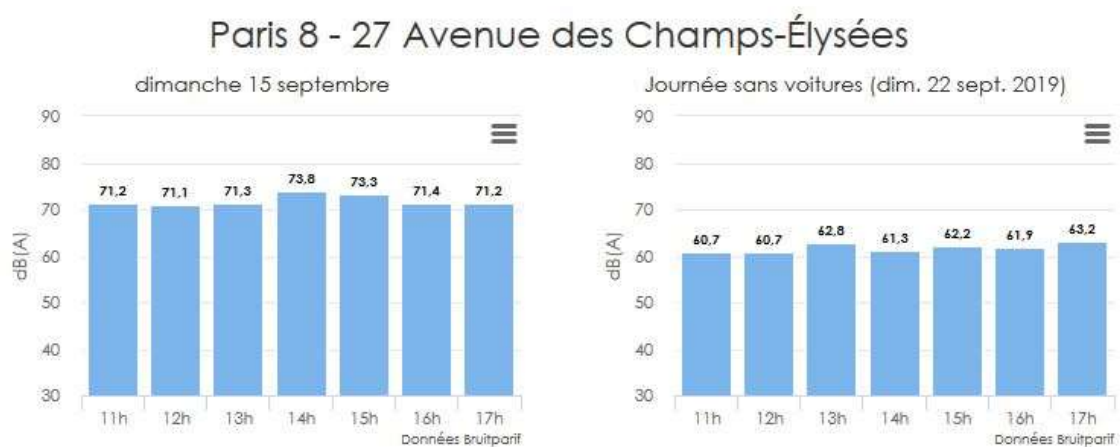
Comparaison entre le dimanche 15 septembre 2019 (circulation habituelle) et le dimanche 22 septembre 2019 (Journée sans voiture) - Résultats heure par heure en dB(A) sur la période 11-18h pour la station située avenue des Champs-Élysées
